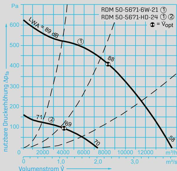
In den Kennfeldern ist der A-bewertete Schalleistungspegel LWA [=LWA3 = LWA8] nach DIN 45635-38 angegeben. Bezugsdichte des Fördermediums  $\rho = 1,15 \text{ kg/m}^3$ .
