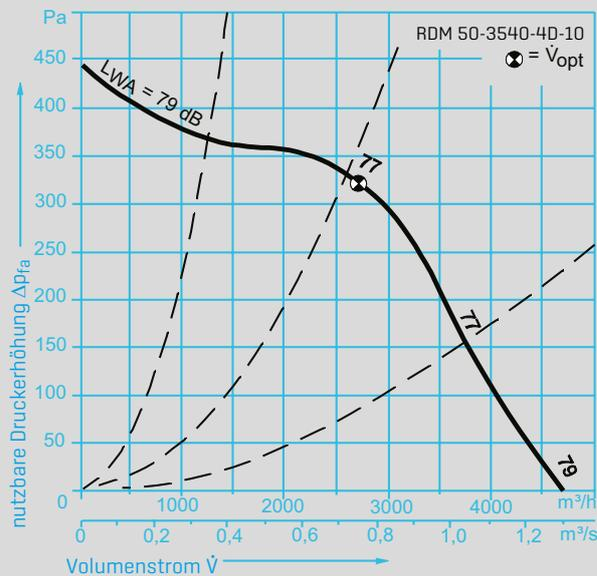
In den Kennfeldern ist der A-bewertete Schalleistungspegel  $L_{WA}$  ( $=L_{WA3} = L_{WA8}$ ) nach DIN 45635-38 angegeben. Bezugsdichte des Fördermediums  $\rho_1 = 1,15 \text{ kg/m}^3$ .
